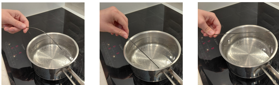
Слика 1.1: Исправљање савијене жице нитинола потапањем у врућу воду.
