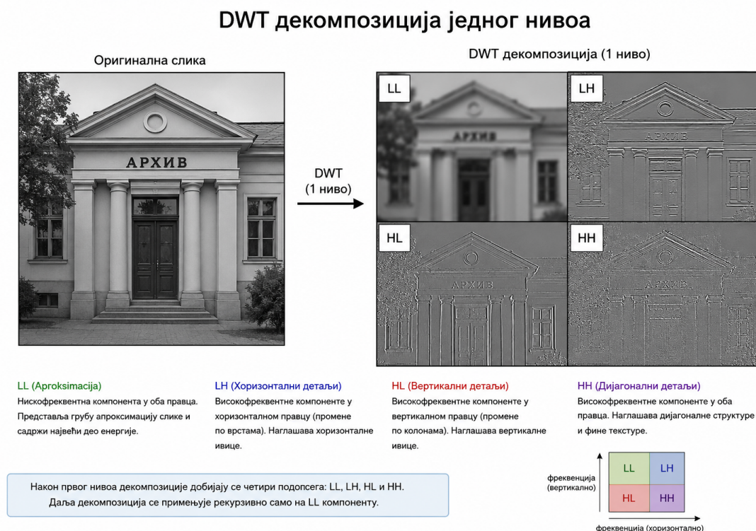
Слика 4.1. Пример једнонивоовске дводимензионе DWT декомпозиције слике на подопсезе LL , LH , HL и HH .
