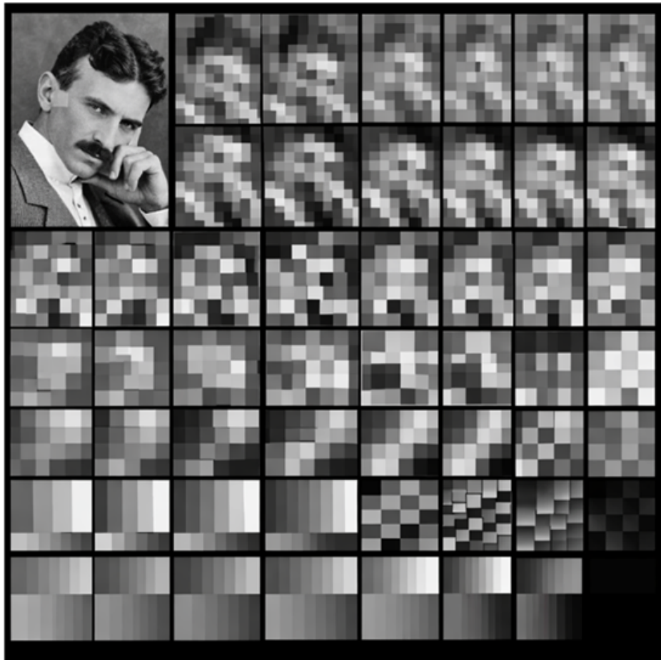
Слика 3.1. Пример дводимензионе декомпозиције дискретне косинусне трансформације (DCT).
