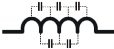
Слика 2.5 - Реални калем - утицај капацитивности између навојака калема
