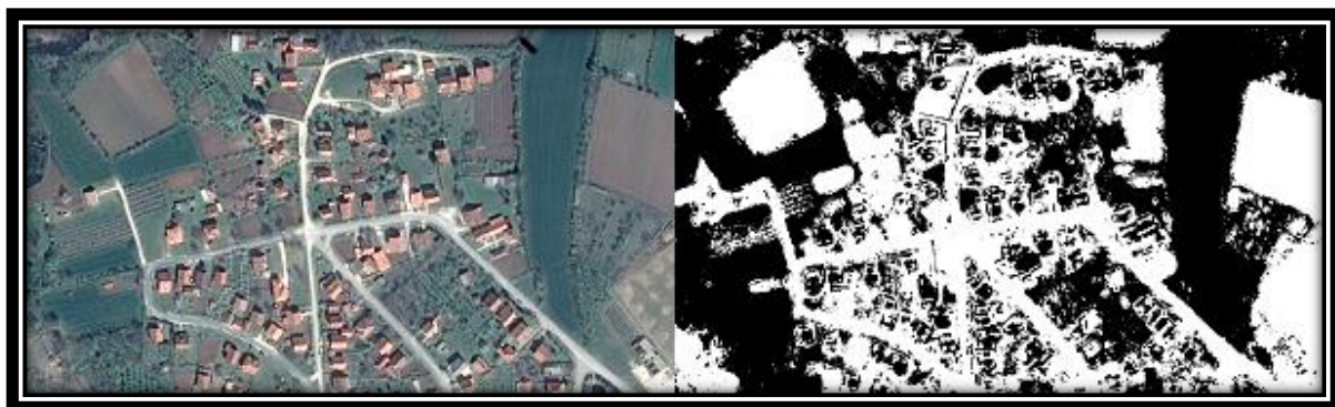
Слика 4 - Бинаризација на основу засићености боје пиксела
