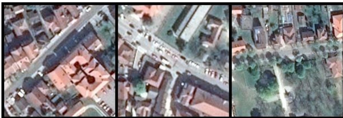
Слика 1 - Сенке, саобраћај и вегетација отежавају детекцију путева
