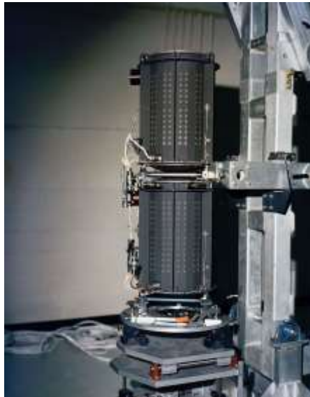
Слика 6: РТГ монтиран на сонди Војажер
