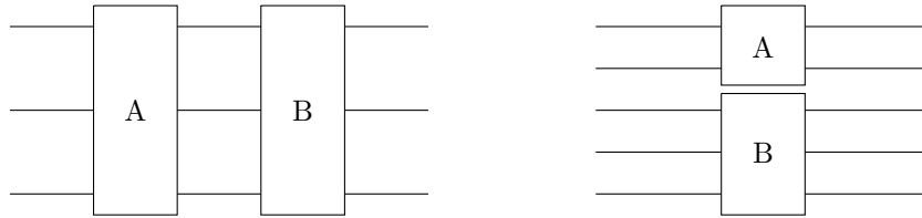
Слика 6: Редно (лево) и паралелно (десно) везана логичка кола A и B
